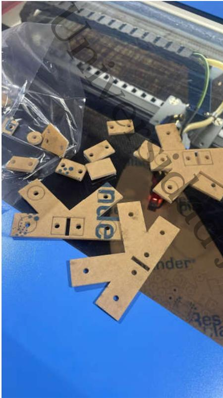
Figura 88. Corte de secciones de acrílico para fabricación de conexión.
