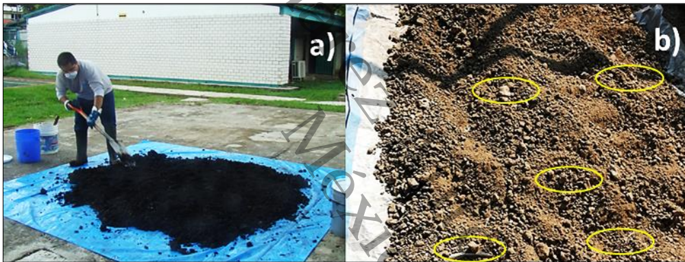
Figura 2. a) homogenizado del material y b) piedras, hojarasca, astillas de madera en el material.
