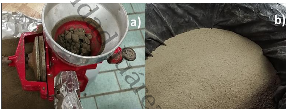
Figura 4. a) molienda del recorte, b) material tamizado.
