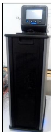
Figura B.1.4 Calibración. a) Baño revuelto o baño térmico, b) Proceso de calibración.
