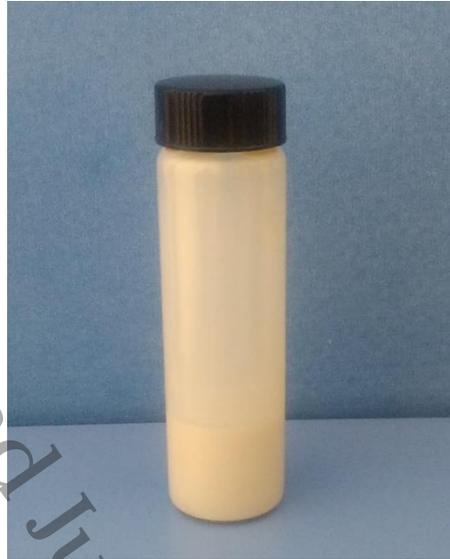
**Figura III.4** Pasta de ZnO obtenida por el proceso propuesto
