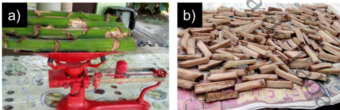
Figura 12. Pesado de la biomasa y secado del material lignocelulósico.
