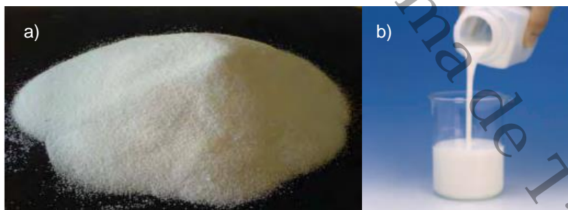
Figura 2.2 PCM micro-encapsulado, a) en polvo, b) disperso en líquido [2, 5].
