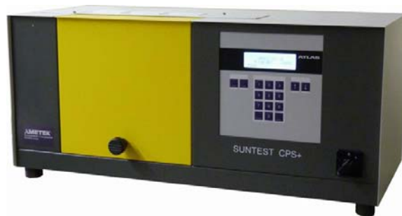
Figura 12. Imagen del simulador solar empleado para las reacciones con fuente de radiación mayor a 400 nm.
