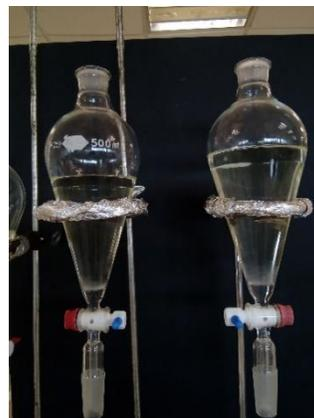
**Figura 39.** Separación de primera fracción extraída mezclada con metanol
