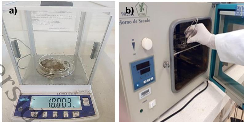
**Figura 18.** a) Pesado de la muestra en la caja petri; b) Muestras llevadas al horno para sequedad a 105 °C
