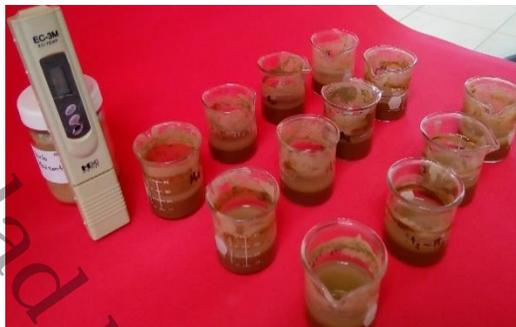
**Figura 13.** Muestras de suelo contaminado para conductividad eléctrica
