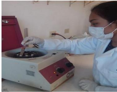
**Figura 37.** Centrifugación del caldo de cultivo después de las 72 h de incubación
