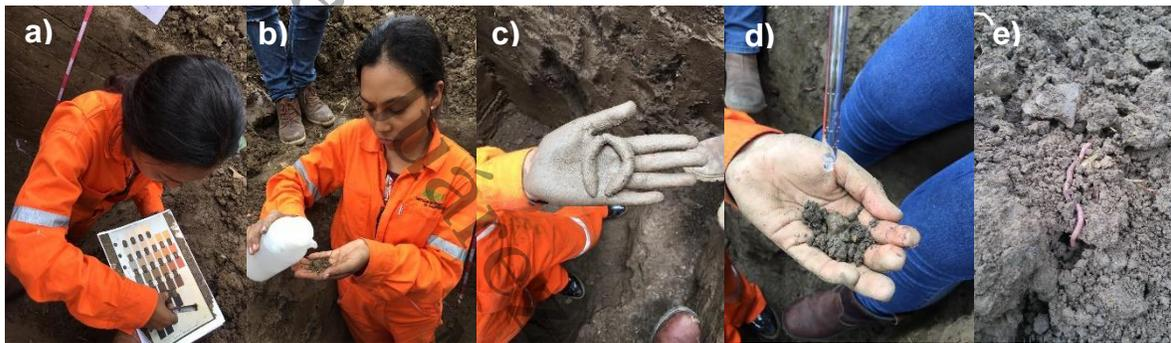
**Figura 10.** Caracterización de algunas propiedades del suelo en campo. a) Color; b) Consistencia en mojado; c) Textura; d) Materia orgánica con  $H_2O_2$ ; e) Presencia de microorganismos
