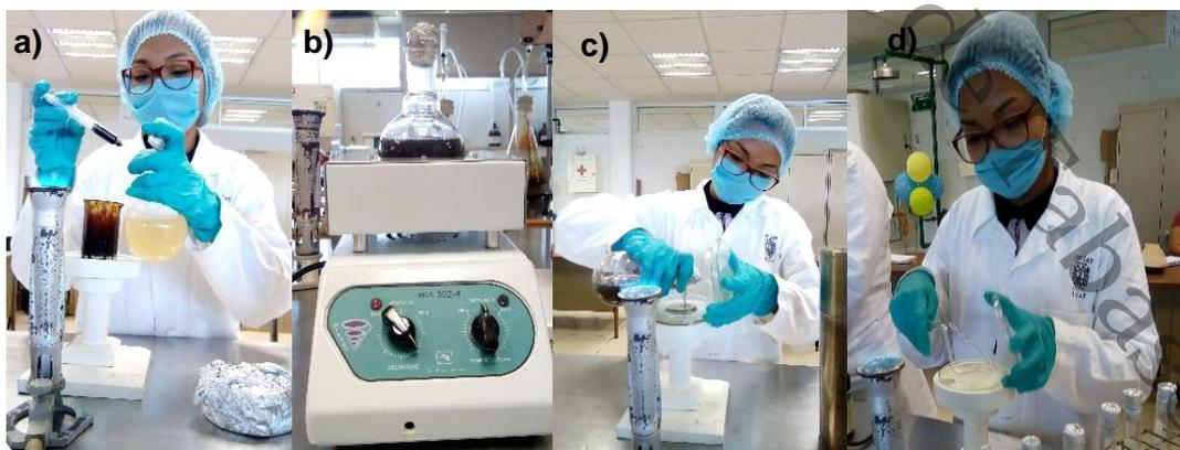
**Figura 24.** Proceso de sembrado a) Adición de hidrocarburo al MSM; b) Homogeneizado de MSM + hidrocarburo; c) Vaciado de MSM en palcas; d) Rastrillado de alícuota de la solución madre
