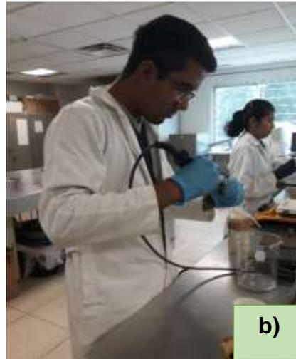
Figura 13 Medición de pH, a) Adición de agua destilada, b) Midiendo el pH mediante el multiparámetro.
