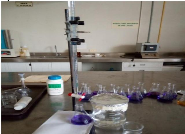
**Imagen 13.** Titulación de las muestras para determinar Nitrógeno.
