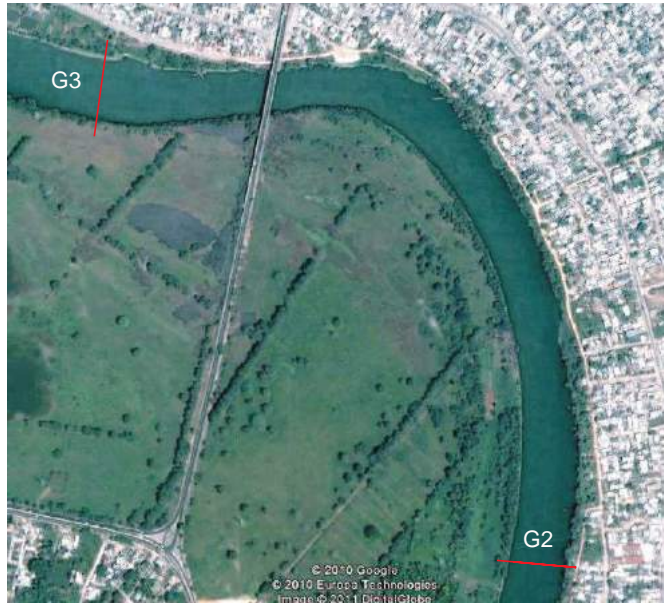
Figura 5.15: Tramo del río Grijalva de G2 a G3. El meandro que se forma en esta parte del río es más complicado de modelar y mide aproximadamente 1 391 m de longitud, de acuerdo con los datos proporcionados.
