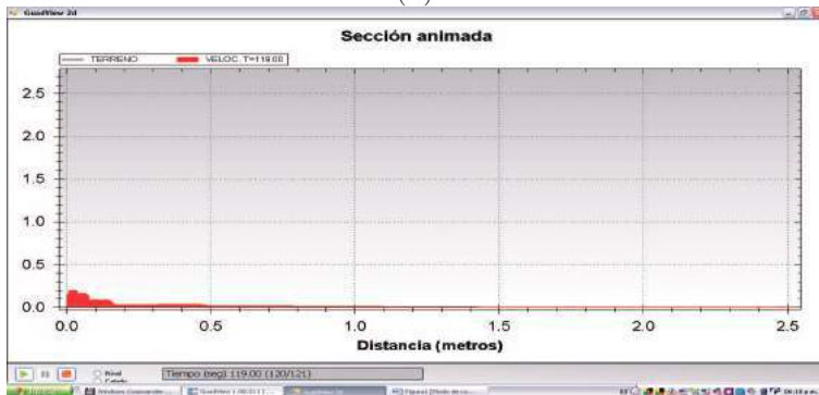
Figura 4.17: Visualización de la velocidad del agua durante la simulación numérica del Ejemplo 2 en una sección horizontal a la altura de la abertura de entrada (véase figura 4.12(B)): (A) a los 2 segundos, (B) a los 15 segundos y (C) a los 119 segundos.
