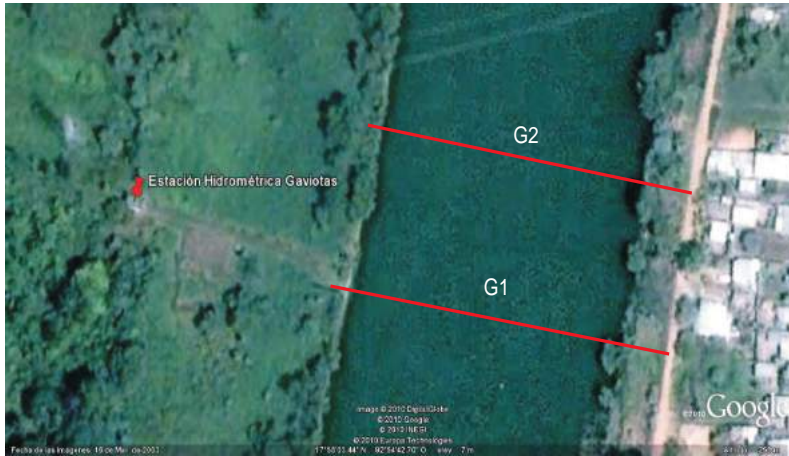
Figura 5.13: Tramo del río Grijalva de G1 a G2. Esta sección es casi recta y mide aproximadamente 50 m de longitud, de acuerdo con los datos que nos fueron proporcionados.
