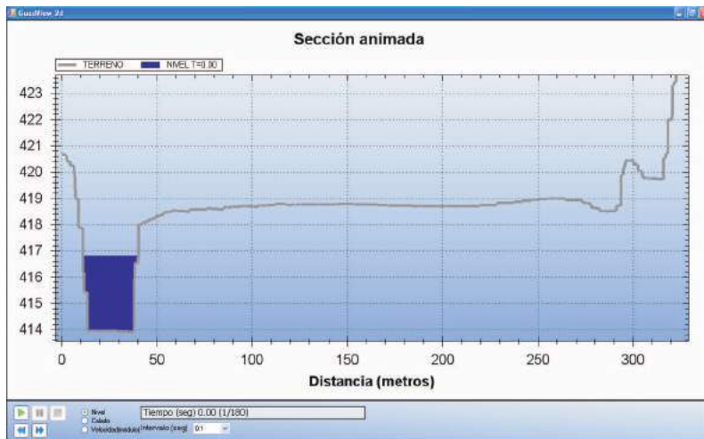
Figura 4.20: (A) Condición inicial para simular numéricamente el desborde de un río sobre una ciudad del Ejemplo 3. (B) El tirante inicial en el río en la sección observada es de aproximadamente 2.80 m.
