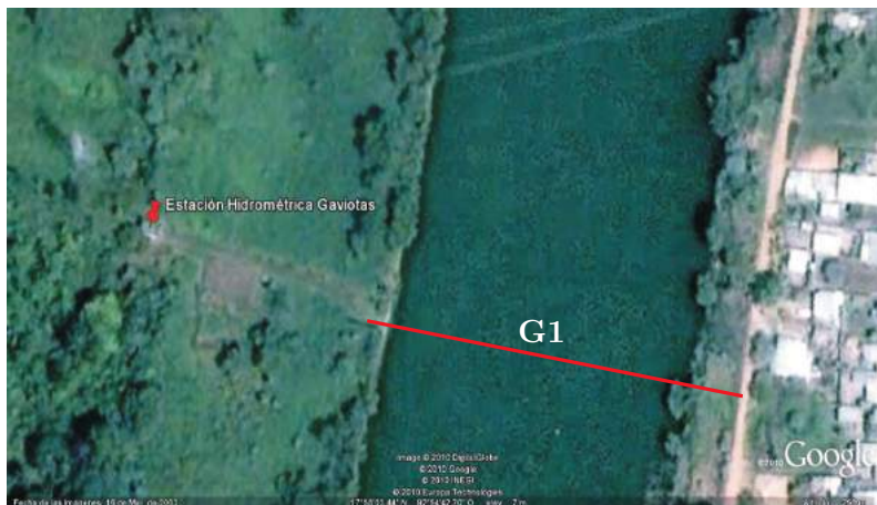
Figura 5.7: Ubicación de la sección transversal G1 frente a la estación hidrométrica Gaviotas, cuyas coordenadas aproximadas en el margen izquierdo del río son: latitud norte = 17^{\circ}58'02.52'' y longitud oeste = 92^{\circ}54'40.03'' , con un ancho aproximado de 121 m.
