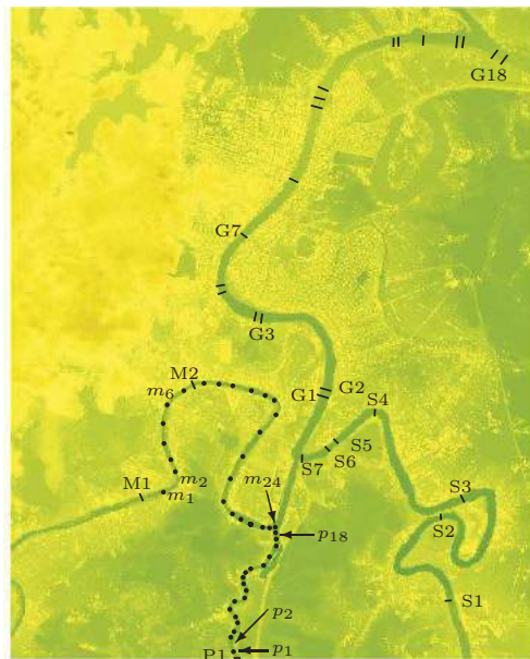
Figura 5.16: Secciones transversales M1 y M2 sobre el río Viejo Mezcalapa y sección transversal P1 sobre el río Pichucalco. En los puntos m_1, m_2, \dots, m_{24} y p_1, p_2, \dots, p_{18} , fue donde se midieron los tirantes en el centro de los ríos Viejo Mezcalapa y Pichucalco, respectivamente, del día 19 de febrero de 2011.
