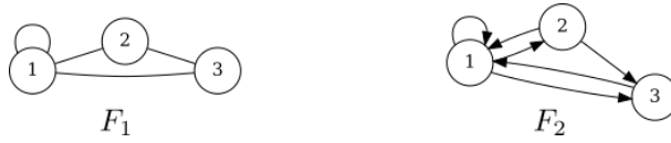
Figura 9.3: El grafo F_1 es un grafo no dirigido, mientras que el grafo F_2 es dirigido, porque no todas las aristas que hay son simétricas.
