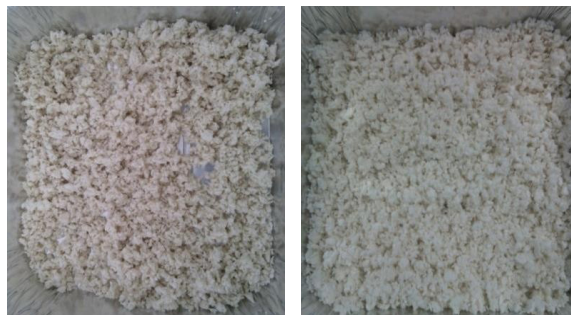
Figura. 1. Detalles de la celulosa extraída de la paja de caña de azúcar, a) celulosa con método de pulpeo, y b) celulosa con método casero.
