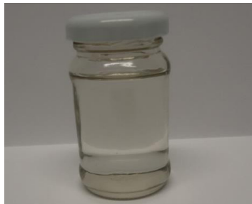
Figura 3. Aceite de coco obtenido de nueces cortadas a madurez fisiológica, sin testa, secado al horno, molido después de secado y extraído en prensa de acero inoxidable
