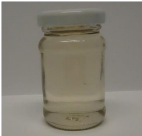
Figura 1. Aceite de Coco obtenido con tratamientos que tienen como factor común la testa, molido antes de secarse, secado al sol y extraído en prensa metálica de acero
