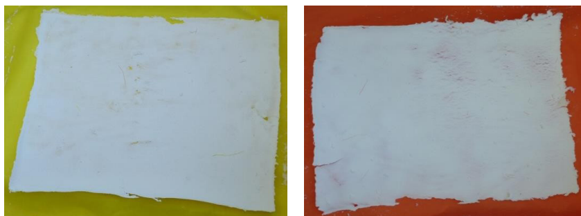
Figura 6. Detalles del papel artesanal elaborado con la celulosa de paja de caña de azúcar a) Método de pulpeo en laboratorio y b) Método casero.
