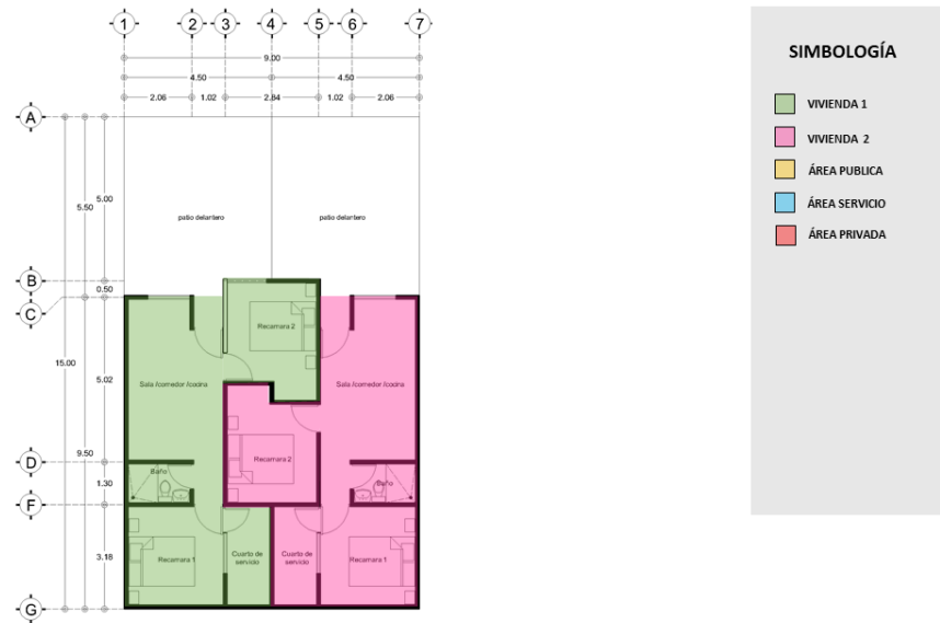
Figura 2. Planta Arquitectónica con división de predios
