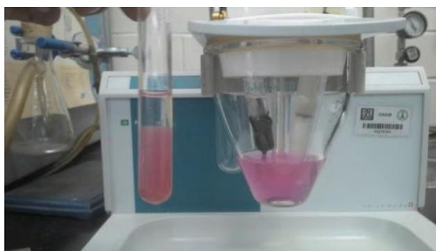
Figura 2. Reacción entre Ni (II) y DMG en medio de KF 1 mol/L. Durante el experimento, fue posible observar la formación de un compuesto poco soluble. El  $Ni(DMG)_2 \downarrow$  suele presentar un color rojo escarlata intenso en medio de  $NH_4^+/NH_3$  (muestra en el tubo de ensayo), pero en medio de KF muestra un color rosa intenso (celda polarográfica), probablemente debido a la interacción del catión metálico con los iones  $F^-$ .
