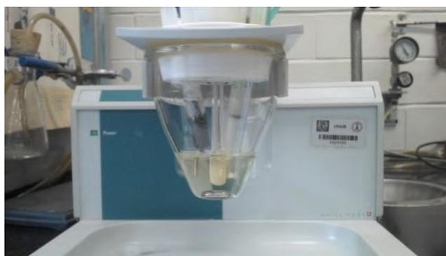
Figura 4. Reacción entre Co (II) y DMG en medio KF 1 mol/L. Durante el experimento fue posible observar un cambio de color en la disolución; desde que se hicieron adiciones de DMG fue adquiriendo poco a poco un ligero color amarillo paja, sin formación de precipitado.
