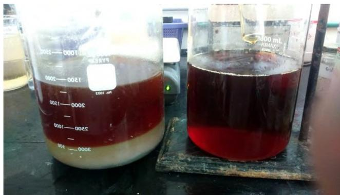
Figura 1. En el vaso del lado izquierdo se muestra a la disolución después de agregarle cal y en el vaso de la derecha se observa la disolución cuando se ha separado de la fase sólida.
