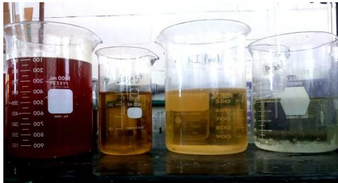
Figura 2. Cambio de coloración de las disoluciones en diferentes etapas del tratamiento con cal. En el primer vaso a la izquierda la disolución es separada de la fase sólida por primera vez. En el segundo vaso, la disolución perdió el mayor contenido de almidón posible. El tercer vaso presenta el característico color ámbar donde se extraen cristales de yoduro. El último vaso a la derecha corresponde a la recrystalización del yoduro de potasio.
