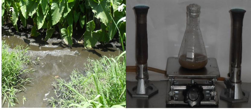
Figura 3.2. a) Muestreo de aguas residuales en canal de desagüe del ingenio; b) preparación de la muestra para siembra de microorganismos.
