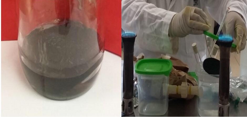
Figura 3.10. Limpieza e instalación de electrodo de fieltro de grafito para cámara anódica.
